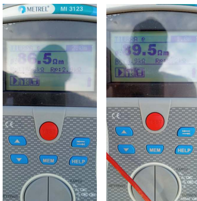
Figura 11. Medición resistividad terreno comunidad indígena La Laguna del municipio de Ríohacha
