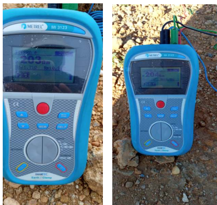
Figura 13. Medición resistividad terreno comunidad Juliakat del municipio de Ríohacha Fuente: Elaboración propia
