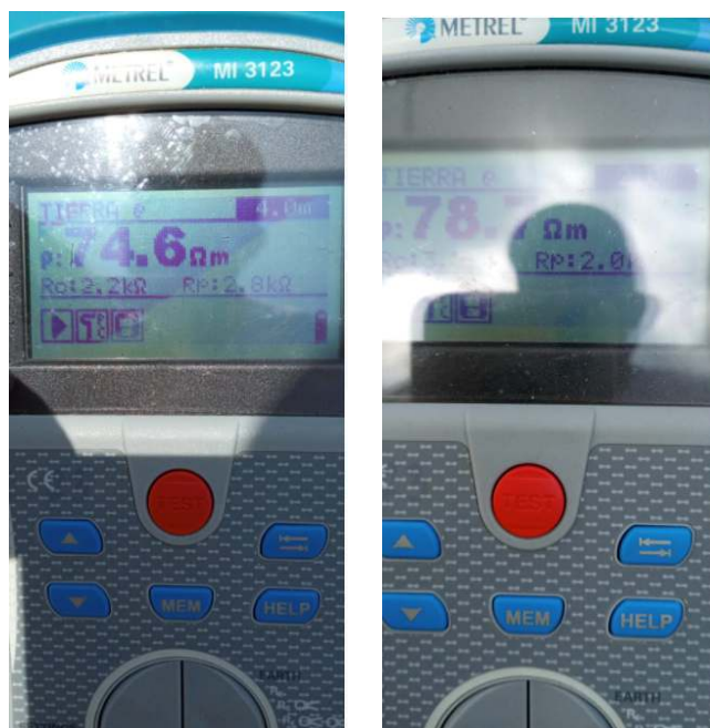
Figura 10. Medición resistividad terreno comunidad indígena Jirrawaikat del municipio de Ríohacha
