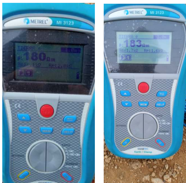
Figura 12. Medición resistividad terreno comunidad indígena Cucurumana del municipio de Ríohacha Fuente: Elaboración propia
