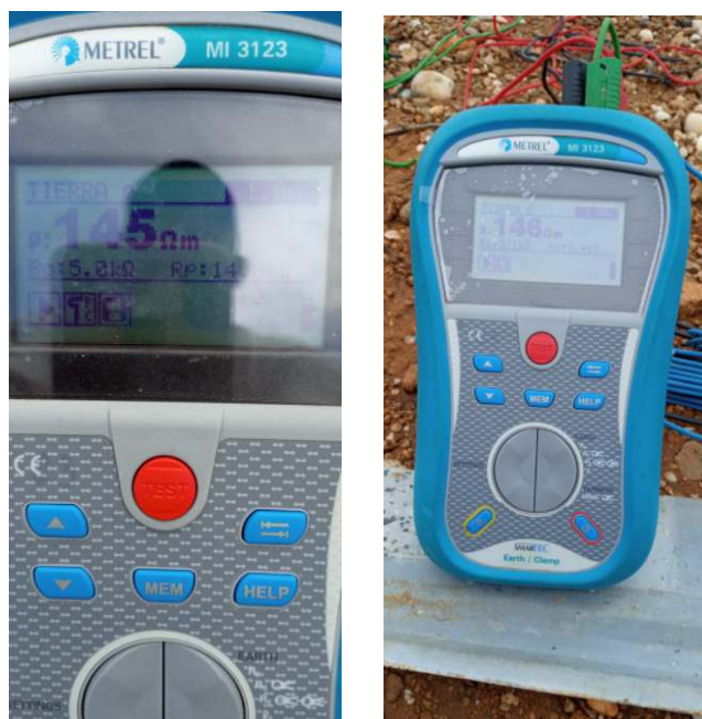
Figura 10. Medición resistividad terreno comunidad indígena Kouripana del municipio de Maicao Fuente: Elaboración propia
