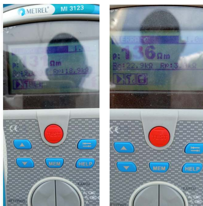
Figura 11. Medición resistividad terreno comunidad indígena Aluatachon del municipio de Maicao Fuente: Elaboración propia
