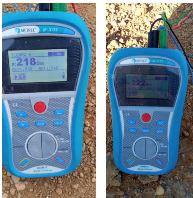
Figura 43. Medición resistividad terreno en la institución educativa tipo VI de la comunidad indígena Yamain del municipio de Maicao Fuente: Elaboración propia
