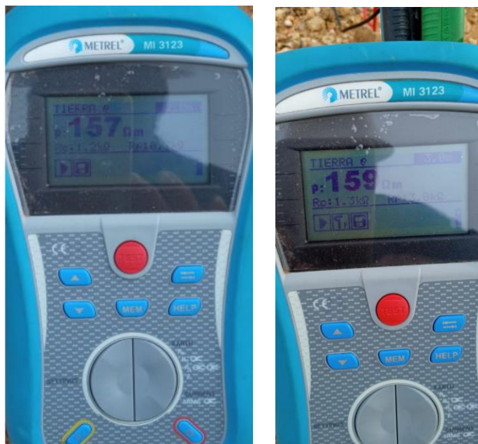
Figura 42. Medición resistividad terreno en la institución educativa tipo V de la comunidad indígena Parritchon del municipio de Maicao Fuente: Elaboración propia
