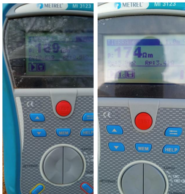
Figura 40. Medición resistividad terreno en la institución educativa tipo II de la comunidad indígena Salarao del municipio de Maicao Fuente: Elaboración propia
