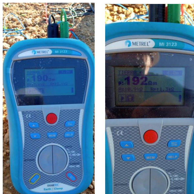
Figura 41. Medición resistividad terreno en la institución educativa tipo IV de la comunidad indígena Olokomana del municipio de Maicao Fuente: Elaboración propia
