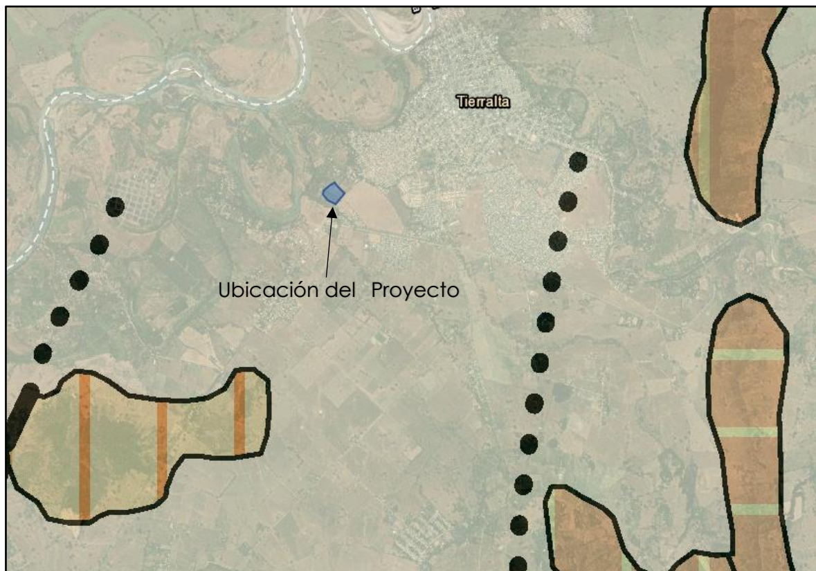
Figura 8. fallas geológicas del sitio de la obra 3
